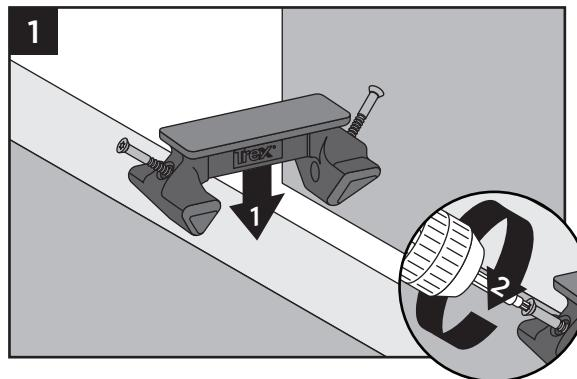
1. Pour les joints extrémité à extrémité, là où les planches se rejoignent sur une seule solive, installez une pince de joints extrémité à extrémité, comme illustré, avec deux vis (fournies avec la pince).
