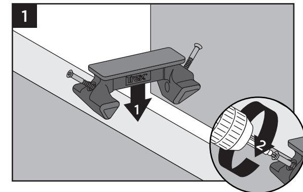
1. Para las juntas de empalme, donde las tablas se encuentran con una sola viga, instale clips de juntas de empalme para compartir las vigas, tal como se muestra, con dos tornillos (suministrados con el clip).
