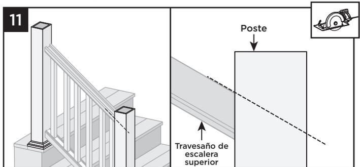
11. Corte el poste y las fundas de poste al ángulo apropiado, de manera que el corte quede a ras con el travesaño superior. Cuide de no cortar el travesaño superior.
