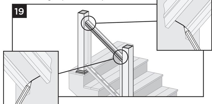
19. Marque ambos postes en el canal interior del travesaño de escalera superior. Retire el travesaño de escalera superior.
