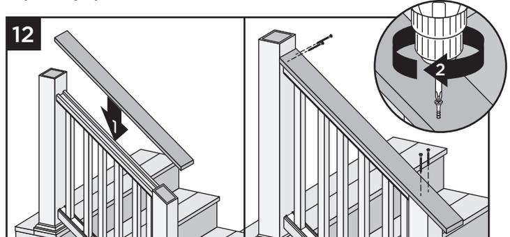
12. Coloque la tabla de entablado sobre el travesaño superior y fije la tabla a los postes utilizando dos tornillos para entablado compuesto recomendados por Trex (use dos tornillos por cada poste).
