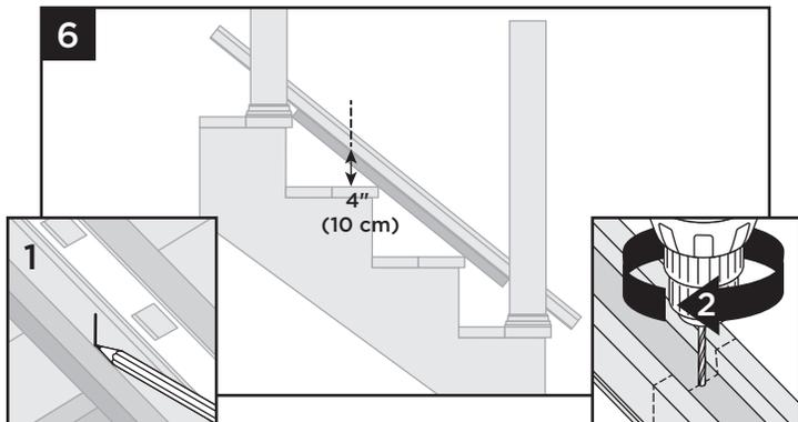
6. Marque la ubicación aproximada del bloque base, dejando una distancia de 4" como máximo. Invierta el travesaño inferior y haga un orificio en la ubicación marcada utilizando una broca de 3/16" en el centro del canal. El bloque base se debe instalar en el último escalón. Para las distancias entre postes de más de 6' en aplicaciones comerciales, marque y perforo dos ubicaciones con espaciamento uniforme para dos bloques base.
