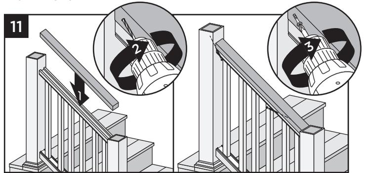
11. Haga previamente un orificio piloto e inserte oblicuamente un tornillo para entablado compuesto de 2-1/2" (6.4 cm) en cada extremo del travesaño de 2 x 4, en el poste del lado posterior del travesaño de escalera (lado opuesto al entablado).
