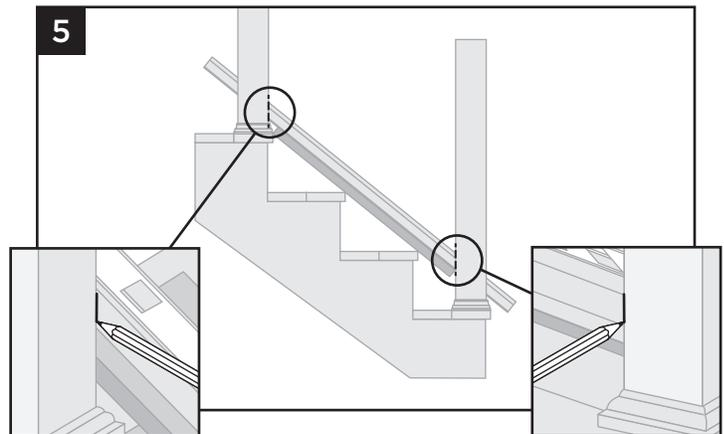
5. Use los postes de escalera inferior y superior para establecer el largo del travesaño de escalera inferior. Asegúrese de que los orificios del espaciador de balaustres tengan una separación uniforme entre los postes. Deje también una distancia mínima de 1-1/2" (292 mm) en cada extremo del travesaño de escalera para la colocación de los soportes y para el espacio libre de los balaustres. Marque el travesaño en las intersecciones con los postes.
