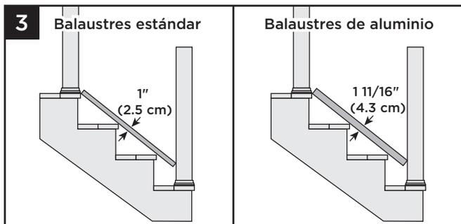
3. Si utiliza balaustres estándar, coloque una tabla de entablado de 1" (254 mm) sobre el saliente del escalón. Si utiliza balaustres de aluminio, use un trozo de madera inservible de al menos 1-11/16" de grosor y colóquelo sobre el saliente del escalón.
