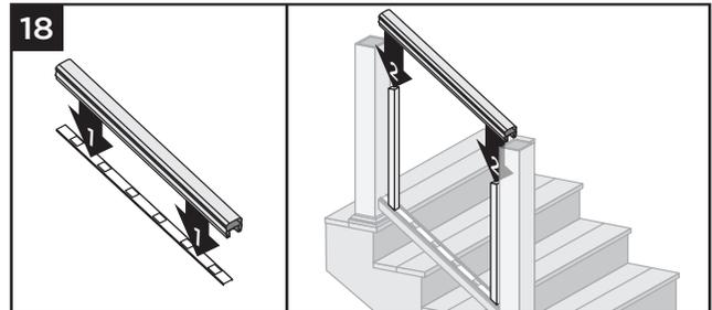
18. Retire el espaciador de balaustres del travesaño de escalera superior y coloque el travesaño entre los postes, **ASEGURÁNDOSE** de que los balaustres se mantengan paralelos al poste.
