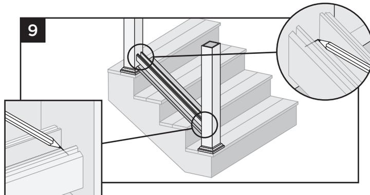
9. Marque ambos postes en el canal interior del travesaño de escalera inferior. Retire el travesaño de escalera inferior.
