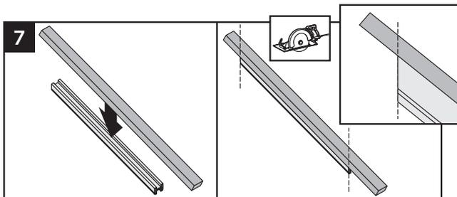
7. Utilizando el travesaño superior cortado como plantilla, corte el travesaño de 2 x 4 al mismo ángulo y largo del travesaño superior.
