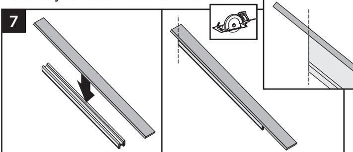
7. Utilizando el travesaño superior cortado como plantilla, corte la tabla de entablado en la ubicación del poste superior al mismo ángulo del travesaño superior. Deje una cantidad generosa de material de tabla de entablado en la ubicación del poste inferior, ya que esto permitirá un voladizo y se puede cortar posteriormente.
