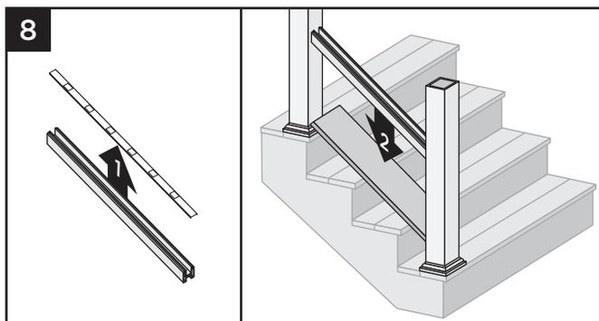
8. Retire el espaciador de balaustres del travesaño inferior y coloque el travesaño entre los postes manteniéndolo sobre la tabla de entablado.
