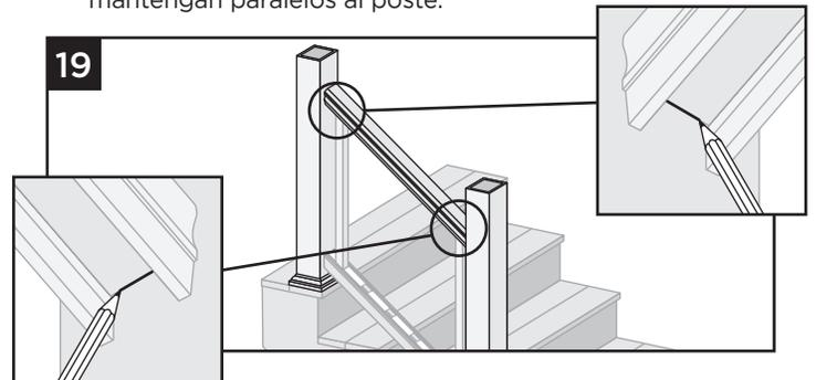
19. Marque ambos postes en el canal interior del travesaño de escalera superior. Retire el travesaño de escalera superior.
