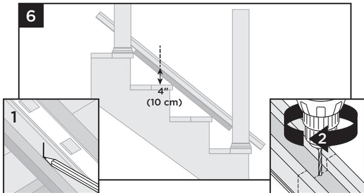
6. Marque la ubicación aproximada del bloque base, dejando una distancia de 4" como máximo. Invierta el travesaño inferior y haga un orificio en la ubicación marcada utilizando una broca de 3/16" en el centro del canal. El bloque base se debe instalar en el último escalón. Para las distancias entre postes de más de 6' en aplicaciones comerciales, marque y perforo dos ubicaciones con espaciado uniforme para dos bloques base.
