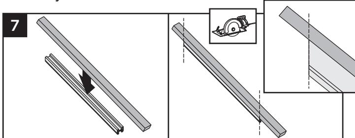
7. Utilizando el travesaño superior cortado como plantilla, corte el travesaño de 2 x 4 al mismo ángulo y largo del travesaño superior.
