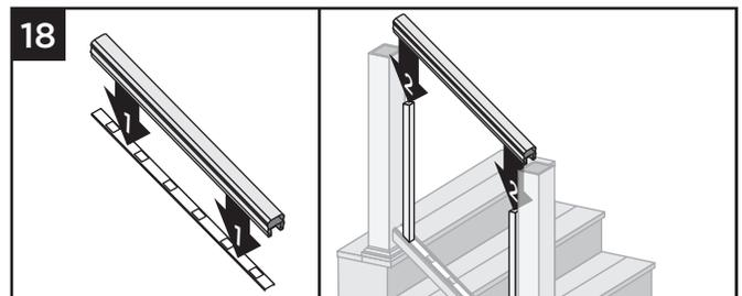
18. Retire el espaciador de balaustres del travesaño de escalera superior y coloque el travesaño entre los postes sobre los balaustres, **ASEGURÁNDOSE** de que los balaustres se mantengan paralelos al poste.
