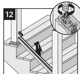
**CONSEJO:** Se puede colocar una tabla de entablado debajo del travesaño de escalera inferior para ayudar a sujetar el travesaño firmemente mientras se fija.
