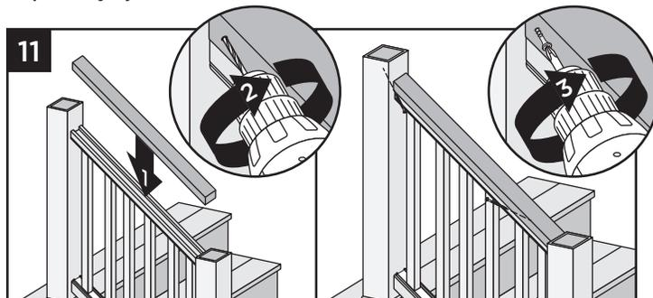
11. Haga previamente un orificio piloto e inserte oblicuamente un tornillo para entablado compuesto de 2-1/2" (6.4 cm) en cada extremo del travesaño de 2 x 4, en el poste del lado posterior del travesaño de escalera (lado opuesto al entablado).
