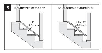
Si utiliza balaustres estándar, coloque una tabla de entablado de 1" (254 mm) sobre el saliente del escalón. Si utiliza balaustres de aluminio, use un trozo de madera inservible de al menos 1-11/16" de grosor y colóquelo sobre el saliente del escalón.
