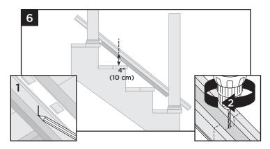
6. Marque la ubicación aproximada del bloque base, dejando una distancia de 4" como máximo. Invierta el travesaño inferior y haga un orificio en la ubicación marcada utilizando una broca de 3/16" en el centro del canal. El bloque base se debe instalar en el último escalón. Para las distancias entre postes de más de 6' en aplicaciones comerciales, marque y perfore dos ubicaciones con espaciamiento uniforme para dos bloques base.
