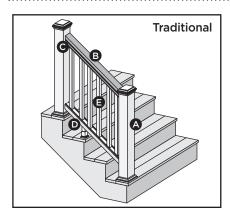
**NO** se requiere cortar las fundas de poste. Asegúrese de que los postes / fundas de poste superior e inferior sean lo suficientemente altos como para dejar espacio para el travesaño superior y el travesaño de 2" x 4" (51 mm x 102 mm).
