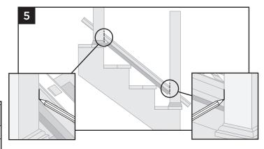
5. Use los postes de escalera inferior y superior para establecer el largo del travesaño de escalera inferior. Asegúrese de que los orificios del espaciador de balaustres tengan una separación uniforme entre los postes. Deje también una distancia mínima de 1-1/2" (292 mm) en cada extremo del travesaño de escalera para la colocación de los soportes y para el espacio libre de los balaustres. Marque el travesaño en las intersecciones con los postes.
