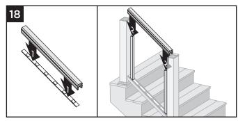
Marque ambos postes en el canal interior del travesaño de escalera superior. Retire el travesaño de escalera superior.
