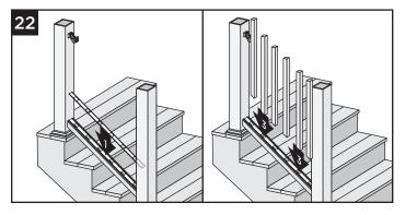
22. Coloque el espaciador de balaustres superior invertido sobre el travesaño inferior / espaciador de balaustres, asegurándose de que los orificios para balaustres estén alineados. Instale los balaustres en el travesaño de escalera inferior.
