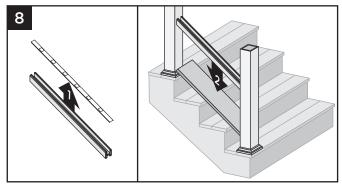
Retire el espaciador de balaustres del travesaño inferior y coloque el travesaño entre los postes manteniéndolo sobre la tabla de entablado.
