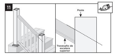
Corte el poste y las fundas de poste al ángulo apropiado, de manera que el corte quede a ras con el travesaño superior. Cuide de no cortar el travesaño superior.
